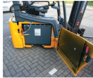
De scharnierconstructie is robuust en de deur opent riant om goed de batterij te kunnen handlen
