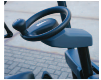
Dankzij het volledig elektrisch stuursysteem kon de stuurkolom aanzienlijk slanker worden en is er meer beenruimte dan op het voorgaande EFG-model
