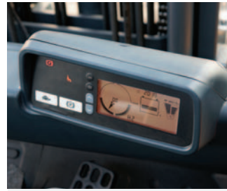
Het display is informatief en compleet; voor optimaal zicht is deze rechts op het schutbord geplaatst
