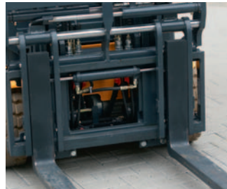
De sideshift/vorkversteller van Bolzoni Auroma maakt het mogelijk om de vork altijd op de juiste breedte te zetten
