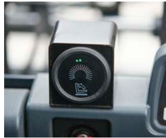
De neighoekindicator is duidelijk een add-on systeem, maar wel praktisch in gebruik; hij geeft nauwkeurig de stand van de mast aan
