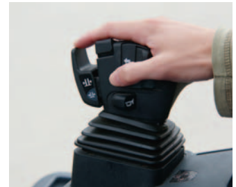
De MULTI-PILOT combineert alle hydraulische functies in één centrale bedieningshendel.
