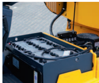
Uit de 24V/1000Ah batterij haalt de Jungheinrich EFG 115 een praktische inzetduur van ruim 9 uur
