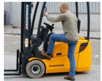
Dankzij voldoende voertuimte, een bescheiden vloerhoogte en een praktische handgreep, is de opstap naar de werkplek op de EFG 115 goed te maken
