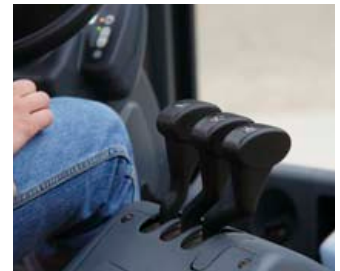
De conventionele SOLO-PILOT hendels bedienen de hydrauliekventielen rechtstreeks en zijn zodoende zeer nauwkeurig bij het positioneren van de vork
