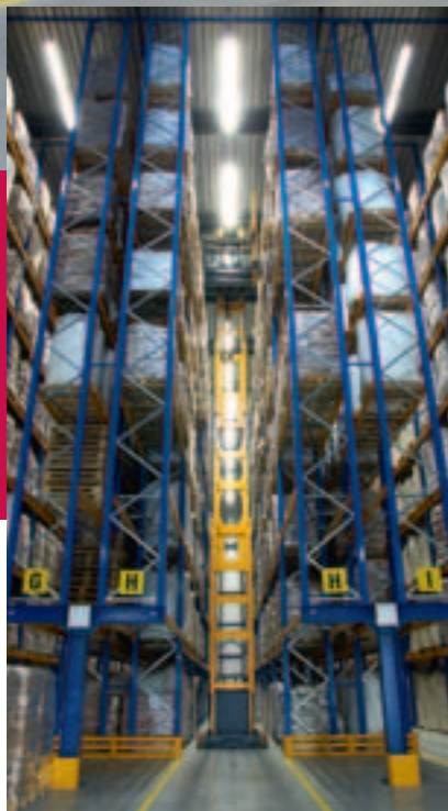
Met een afzethoogte van 15,22 meter bereikt het mens-bediende hoogbouw magazijn van Jonker & Schut een recordhoogte
